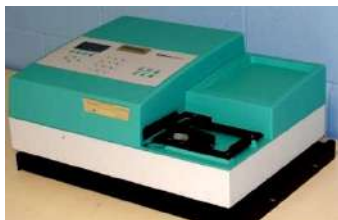
9. Lector de absorbancia para Placas 96-well Multiskan KII Plus (Titertek)
