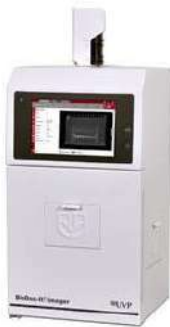
7. Equipo de adquisición de imágenes de geles de agarosa/DNA y proteínas BioDoc-iT deUVP.
